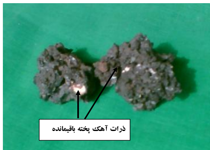
شکل 2. وجود ذرات آهک پخته باقیمانده در سینتر دارای اندازه ذرات آهک پخته 0-10 mm
