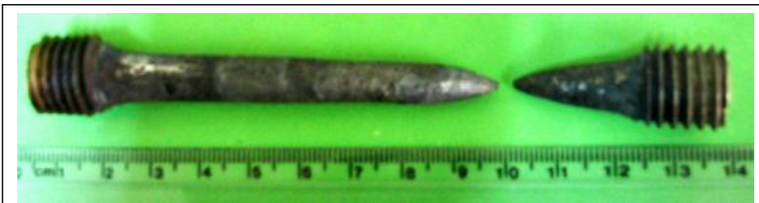
د) نمونه ارسنیک‌دار پس از آزمایش کشش در دمای 1100^{\circ}\text{C}
