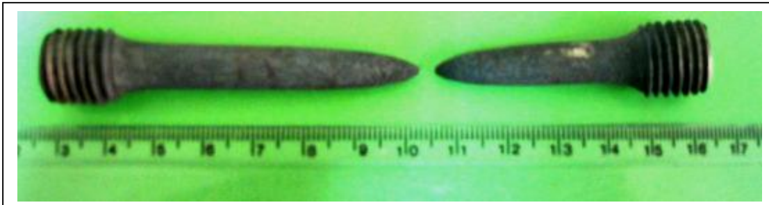
الف) نمونه بدون ارسنیک پس از آزمایش کشش در دمای 800^{\circ}\text{C}
