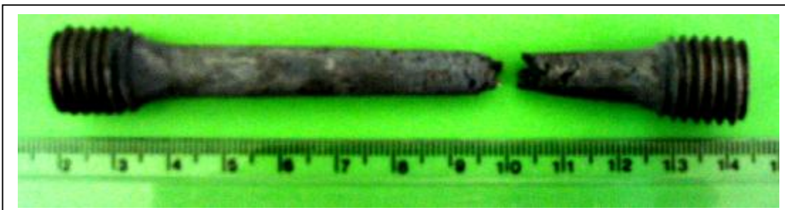
ج) نمونه ارسنیک‌دار پس از آزمایش کشش در دمای 800^{\circ}\text{C}
