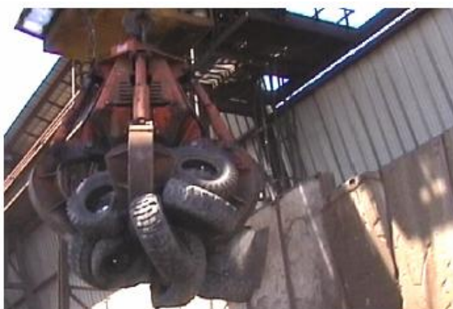
شکل - ۳ : حمل لاستیک ها توسط چنگک به کوره
